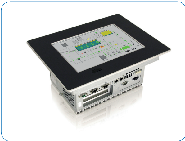
Bild 2: Die Kontron Panel-PC hosten mindestens 95 Prozent der Steuerungsaufgaben und dienen zugleich als Server für die Prozessvisualisierung.
